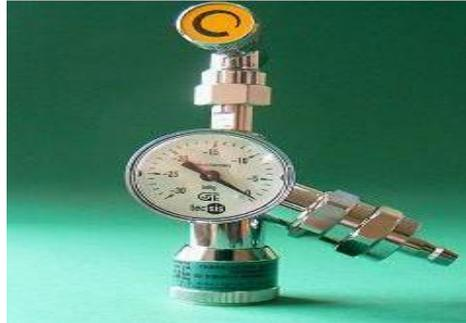
Los manómetros tienen diferentes escalas de acuerdo al rango de presión que se requiere medir. Normalmente las escalas vienen graduadas en psi .
